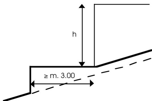
Muro di sostegno a distanza  $\geq m\ 3.00$
