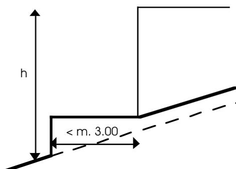
Muro di sostegno a distanza  $< m\ 3.00$
