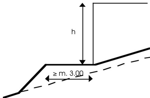
Terrapieno con scarpata a distanza  $\geq m\ 3.00$
